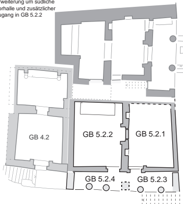
Abb. 38: Schematische Darstellung der Bauphasen in relativer Chronologie und im Verhältnis zur Nachbarbebauung; 2022
