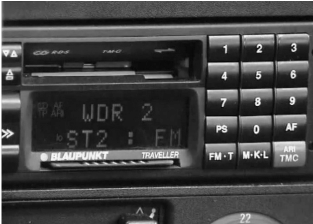
Abbildung 3: Ursprüngliches TMC-Autoradio zur Ausgabe der Meldungen in künstlicher Sprache (Screenshot aus WDR-PR-Film von 1994 zum Projekt „BEVEI“)
