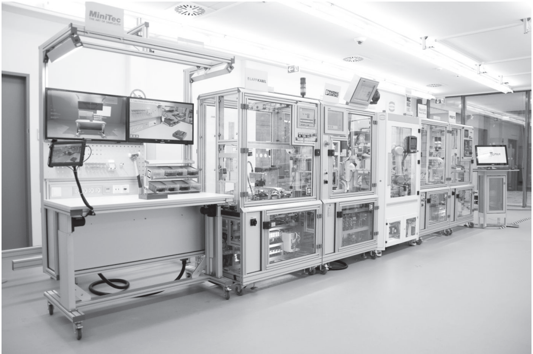
Abbildung 2: Test- und Demonstrationsanlage der Technologie-Initiative SmartFactory KL e.V. mit den herstellereinspezifischen Produktionsmodulen
