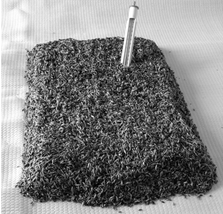
Abb. 7: Schwarze Gerste syrischer Provenienz im Stadium des Greifhaufens 36 auf einer Schilfmatte in der Tennenmälzerei 37 .
